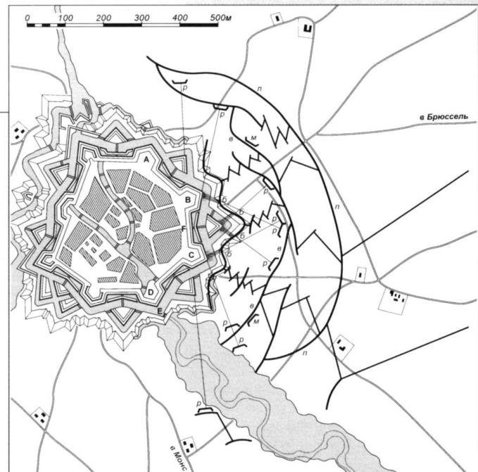
Атака крепости Ат в 1697 году. Обозначения: А — Брабантский бастион, В — бастион Лимбург, С — бастион Намюр, D — Бургундский бастион, Е — шлюз, F — Брюссельские ворота. p — рикошетные батареи, m — мортирные батареи, б — брешь-батареи, п-п — первая параллель, в-в — вторая параллель.
